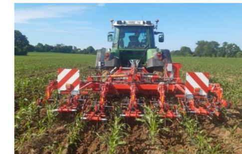
Bineuse Einboeck 6 rangs avec guidage caméra
